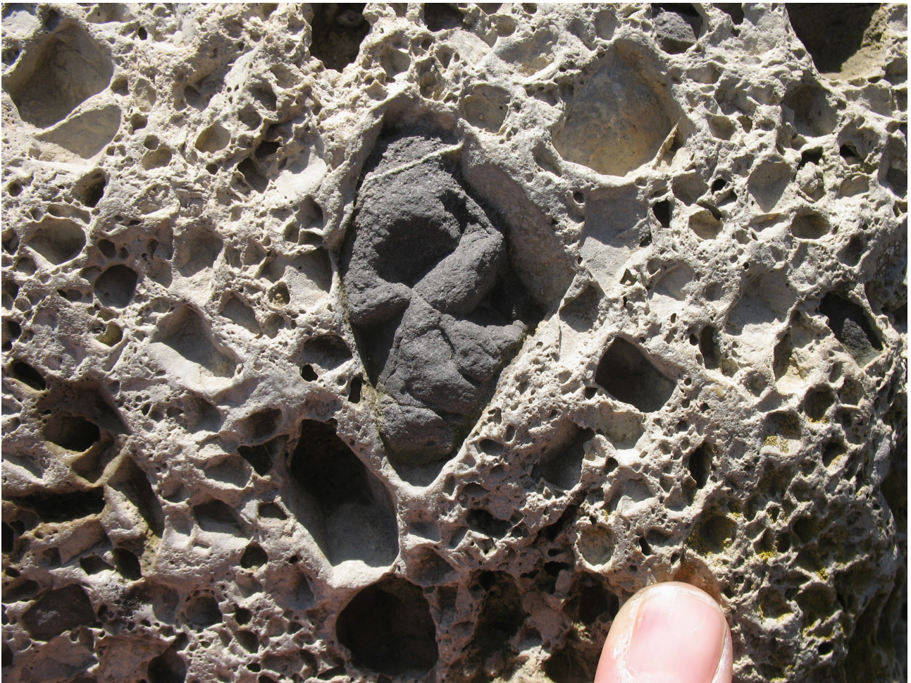
Fig. 6 – Il Calcare cavernoso ( caprone ) è una breccia formata esclusivamente dalla cementazione di frammenti di rocce dolomitiche. L'aspetto cavernoso non dipende dalla dissoluzione di frammenti di gesso ma dalla disgregazione dei clasti dolomitici che hanno subito il fenomeno della de-dolomitizzazione (foto S. Lugli).
