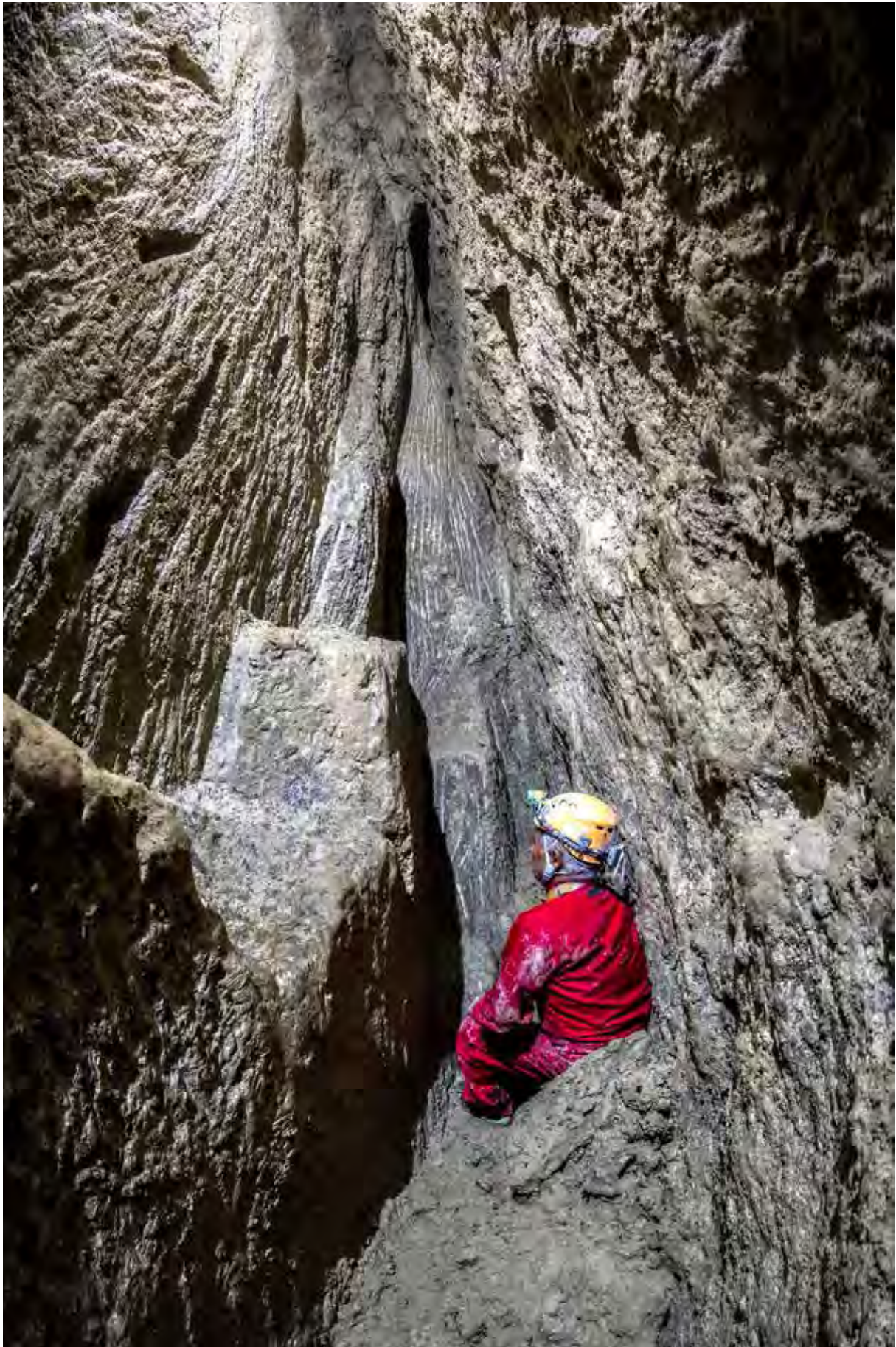
Fig. 60 – Brisighella (RA), Grotta della Lucerna. Fessura ampliata artificialmente per consentire l'estrazione del lapis specularis . Da notare le diffuse tracce di scalpellature, le tacche per l'inserimento di pioli e la presenza di una mensola (foto P. Lucci).
